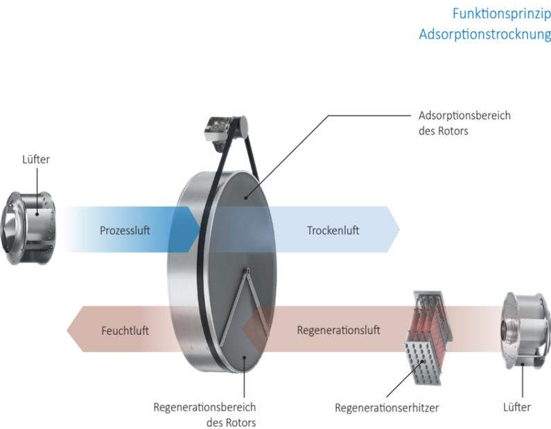
dener, bauseitiger Medien wie z. B. Dampf oder Warmwasser mit dem elektrischen Regenerationserhitzer.
