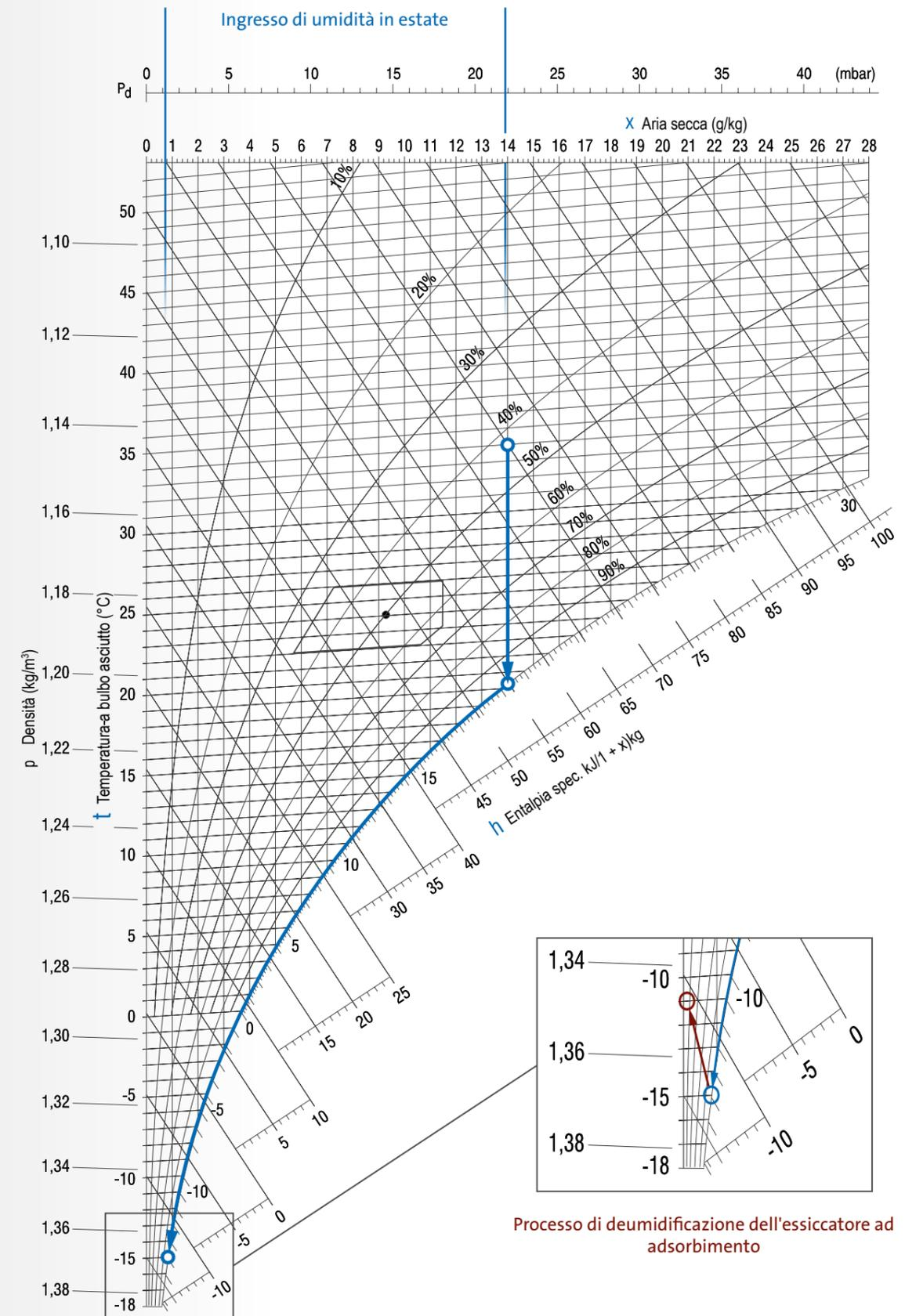
Processo di deumidificazione dell'essiccatore ad adsorbimento
