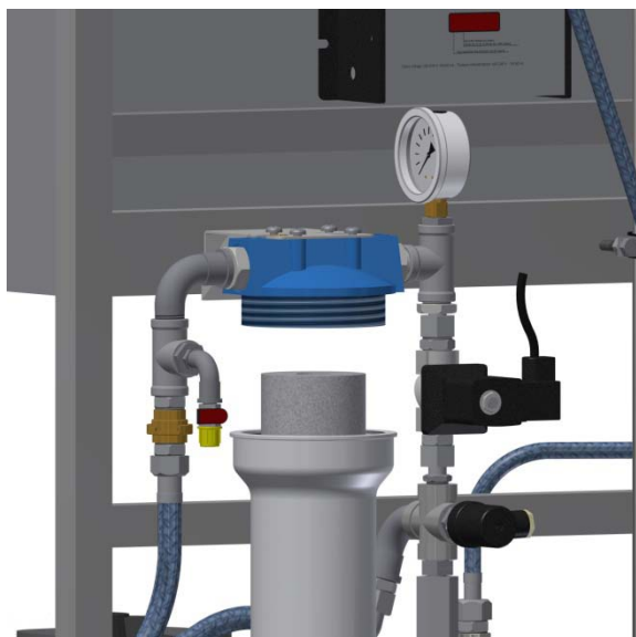
Fig. 52: Installazione filtro ingresso
