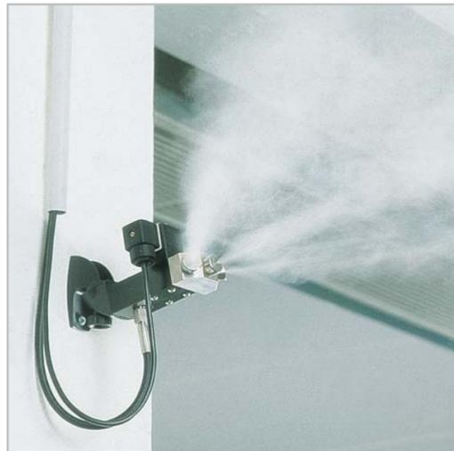
Ce système d'humidification de l'air a été spécialement conçu pour les applications spéciales (humidité supérieure à 80%, zones explosives...) et les sites de production de surface et de volume importants. Il permet une pulvérisation très fine de l'eau et une dispersion rapide dans l'air ambiant. La régulation du taux d'humidité de l'air s'effectue à l'aide d'un dispositif de contrôle central équipé d'un humidistat qui assure la stabilité du taux d'humidité désiré.
