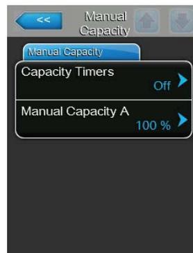
Lasciare la funzione timer disattivata (Capacity Timers: "**Off**") o disattivare la funzione timer se necessario. Definire quindi con il parametro "Manual Capacity A" la limitazione fissa della portata in %, riferita alla portata massima di umidificazione (Settaggio di fabbrica: **100%**, campo di regolazione: **20 ... 100%**).
