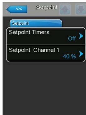
Lasciare la funzione timer disattivata (Setpoint Timers: "Off") o disattivare la funzione timer se necessario. Determinare quindi con il parametro "Setpoint Channel 1" il valore setpoint fisso dell'umidità (Settaggio di fabbrica: **40 %u.r.**, campo di regolazione: **5...95 %u.r.**).
