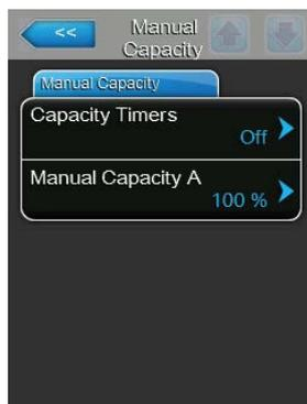
Lasciare la funzione timer disattivata (Capacity Timers: "Off") o disattivare la funzione timer se necessario. Con il parametro "Manual Capacity A" definire la limitazione fissa della portata in % riferita alla portata massima di umidificazione (Settaggio di fabbrica: **100 %**, campo di regolazione: **20 ... 100 %**).
