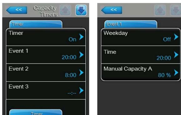
Attivare la funzione timer (Capacity Timers: "On").
