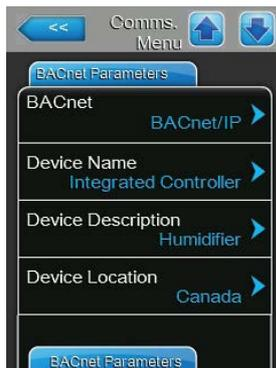
Le seguenti impostazioni compaiono solo se il parametro "BACnet" è impostato su "BACnet/IP".
