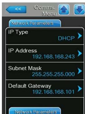
Le seguenti impostazioni di rete sono necessarie solo per la comunicazione attraverso l'interfaccia IP BACnet integrata.
