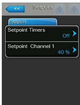
Lasciare la funzione timer disattivata (Setpoint Timers": "**Off**") o disattivare la funzione timer se necessario. Determinare quindi con il parametro "Setpoint Channel 1" il valore setpoint fisso dell'umidità (Settaggio di fabbrica: **40 %rF**, campo di regolazione: **5...95 %rF**).
